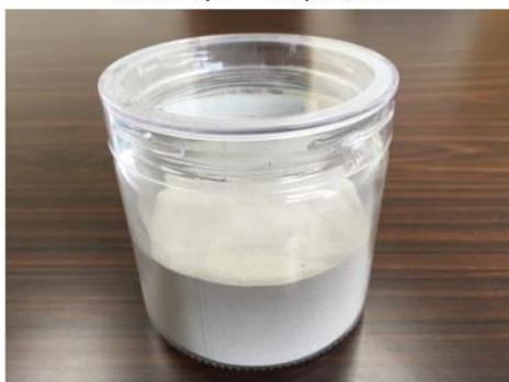
固形化した触媒(直径 $2\sim 3\text{mm}$ )
