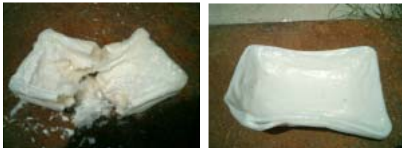
図 3. オートクレーブ後の PLLA(左)と PET(右)製卵パック. 反応条件：130℃ (0.276MPa)、90min
