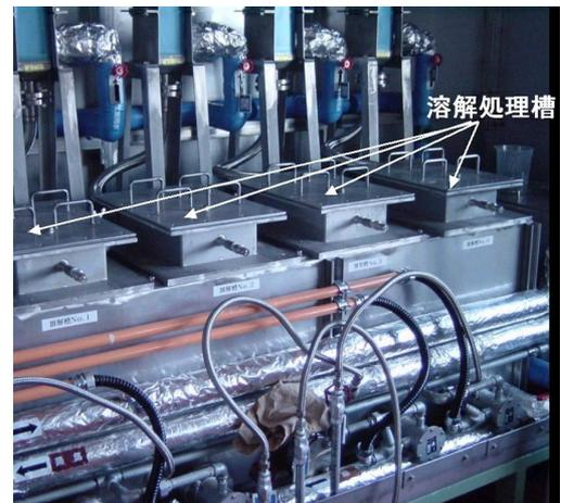
図1 溶解処理槽
