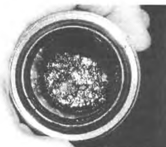
Fig.1 単純熱分解により得られる生成物
